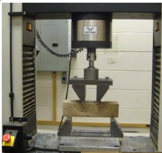
Figura 616 - 2. Ensayo de flexión sobre una viga de suelo-cemento
